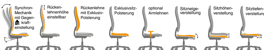
Sitzneigeautomatik. Sitzfläche neigt sich automatisch nach vorne bei Gewichtsverlagerung
